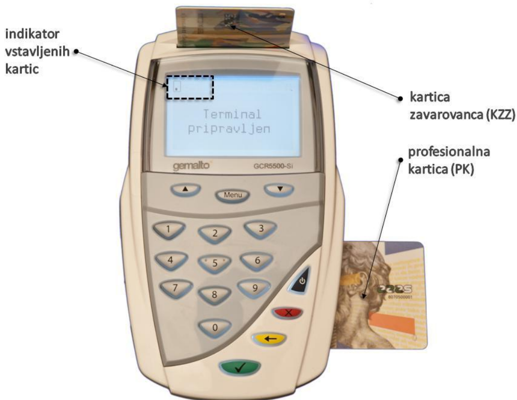
Slika 4: Vstavitev pametnih kartic v čitalnik GCR5500-Si
