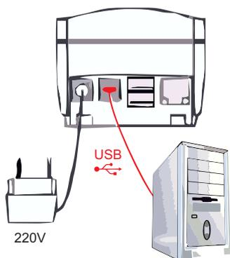
Po uspešni namestitvi gonilnika priključite čitalnik GCR5500-Si na napajanje izključno s priloženim pretvornikom in na priključek USB na računalniku s priloženim kablom USB, kot kaže slika. Čitalnik vključite z daljšim pritiskom na tipko Vklop/Izklop.
